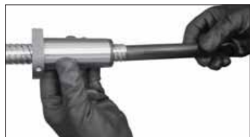
4.将螺母全部转入丝杆轴上,确认螺母全行程都转入丝杆轴后才能转套筒移开。
